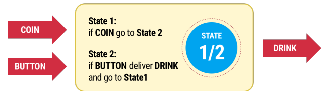
Figura 2. Modelo de una máquina expendedora de gaseosas en términos de una máquina de estado.
